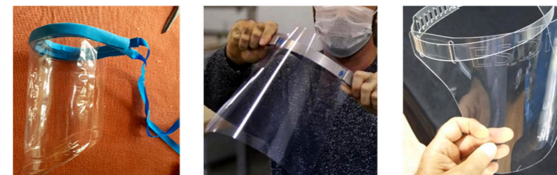
Figura 3. Objeto quirofaturado com diversos materiais disponíveis à sua construção. Produto manufaturado com materiais (acetato e metal) industriais e auxílio de mãos, ferramentas e máquinas. Produto maquinofaturado com um único material em máquinas de prototipagem rápida. Fonte: t.ly/FloA - t.ly/c6-Q - t.ly/dWdP
